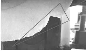
圖 1 因工件傾倒而撞壞之砂輪
