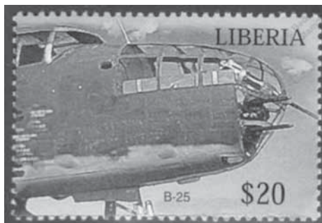
圖五：B-25D機首強大火力的機炮，適合執行低空轟炸任務。
