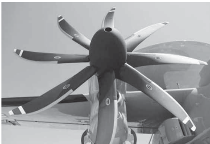
現役E-2系列空中預警機均換裝八槳葉的NP2000螺旋槳。
