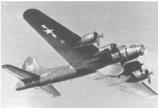
PB-1W（B-17G 改裝）預警機，雷達裝於機腹處。
