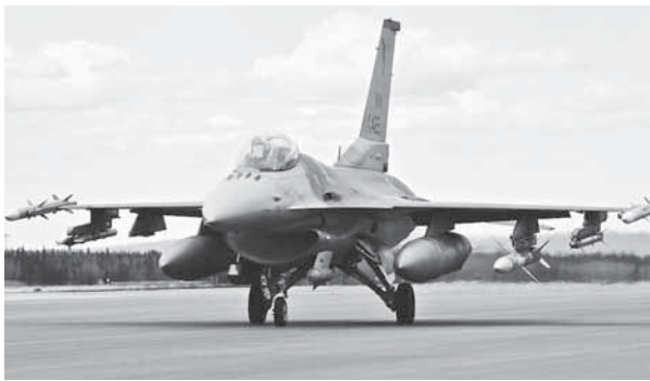
在艾爾森基地大坪滑行中的第13中隊F-16CJ反輻射攻擊機，攜載AN/AAQ-33標定英艦與AGM-88 HARM高速反輻射飛彈。5月5日
