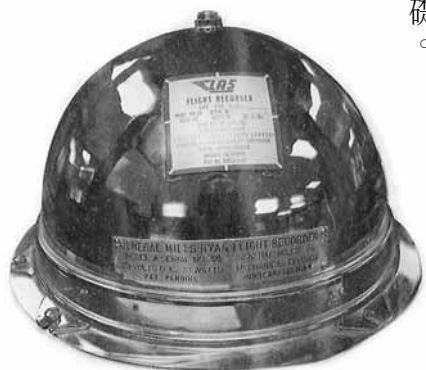
雷安製模型A之飛航資料紀錄儀原型機，能記錄高度、空速及加速度。
