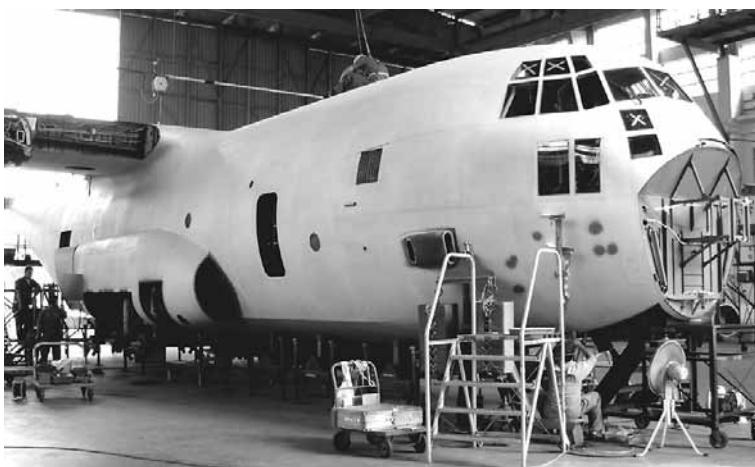
C-130型機PDM廠修情況。
