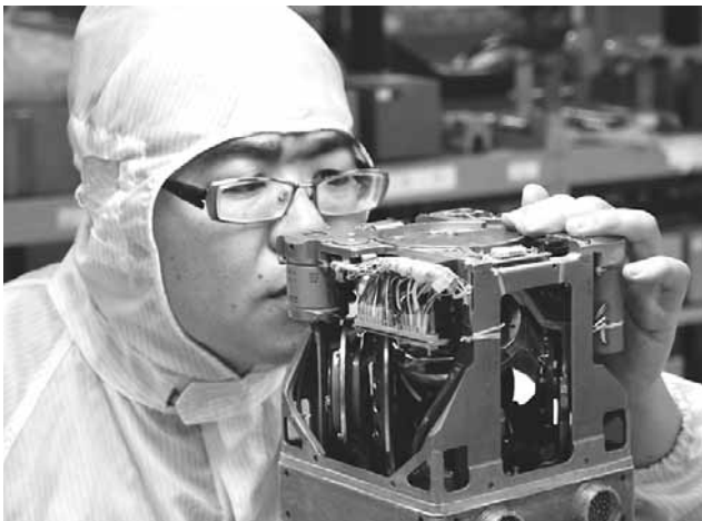
執行陀螺儀錶修護作業。
