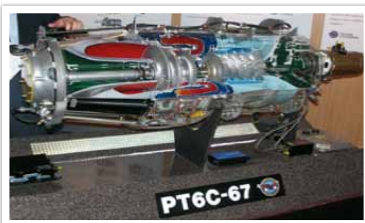
圖六 武直-10原型機使用普惠公司的發動機
