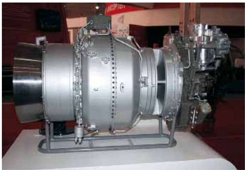
圖八 中航工業與法國聯合研製的渦軸-16發動機
