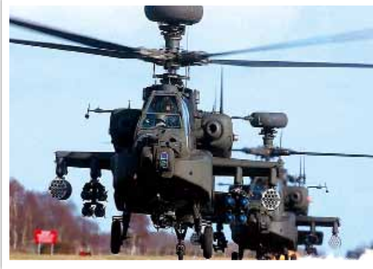
圖九 AH-64E主旋翼上方裝置長弓毫米波雷達系統
