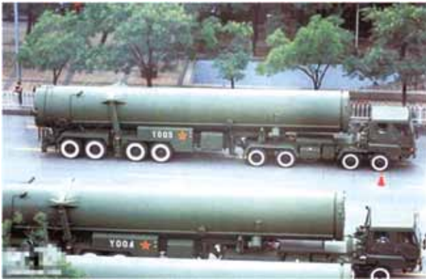
圖六 東風31A洲際飛彈以牽引車為運載一起豎一發射車，因局限在公路上使用，因而影響其戰場上的存活率。
