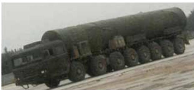
圖七 東風31B洲際飛彈以8軸驅動輪型車為運載一起豎一發射車，是專門設計在崎嶇地形或其他困難路況下機動與發射的系統，其發射陣地幾乎不可能被敵方發現，對敵方具有極高的戰略威脅性。
