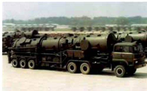
圖二 中共東風21-A型彈道飛彈以6軸拖車為運載-起豎-發射車(TEL)，因機動性能有限而未大量生產。
