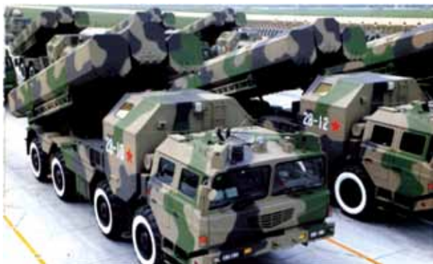
圖八 中共長劍-10(東海-10)長程攻陸巡航飛彈以4軸驅動輪型車承載與發射，每車配置3箱飛彈，自中國大陸內地發射，其射程可覆蓋日本、韓國的美軍基地。
