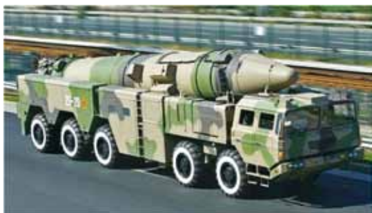
圖三 中共東風21C型彈道飛彈以5軸驅動輪型車為運載-起豎-發射車，係針對反制美國飛彈防禦系統而研發的中程彈道飛彈。
