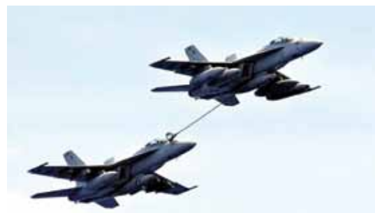
圖三 美國F/A-18黃蜂號戰機正在進行「夥伴式」空中加油
