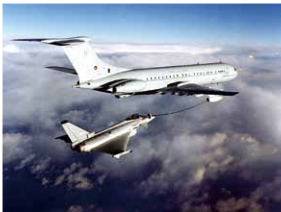
圖九 英國之VC-10加油機正在為戰機實施空中加油 資料來源： http://www.deagel.com/library/RAF-VC10-refueling-Typhoon_m02006120200461.aspx
