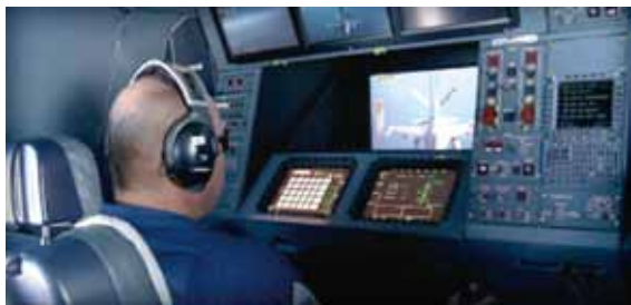
圖十一 A330 MRTT之加油操作控制系統
