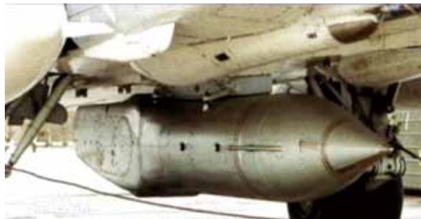
圖八 IL-78加油機之UPAZ-1A空中加油吊艙
