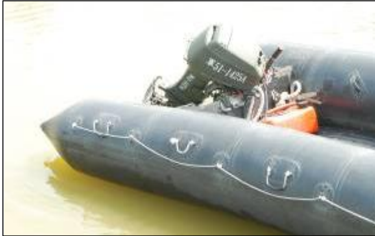
圖二十 40 匹操舟機研改護罩水上操行測試
