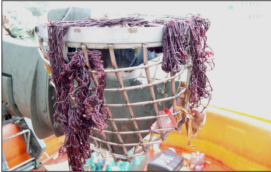
圖十四 40 匹操舟機研改護罩測試結果
