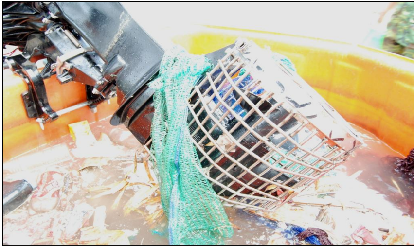
圖十二 30 匹操舟機研改護罩測試結果
