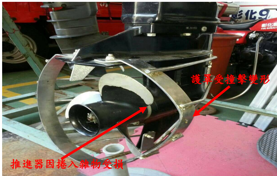
圖三 操舟機推進器及護罩損壞情形
