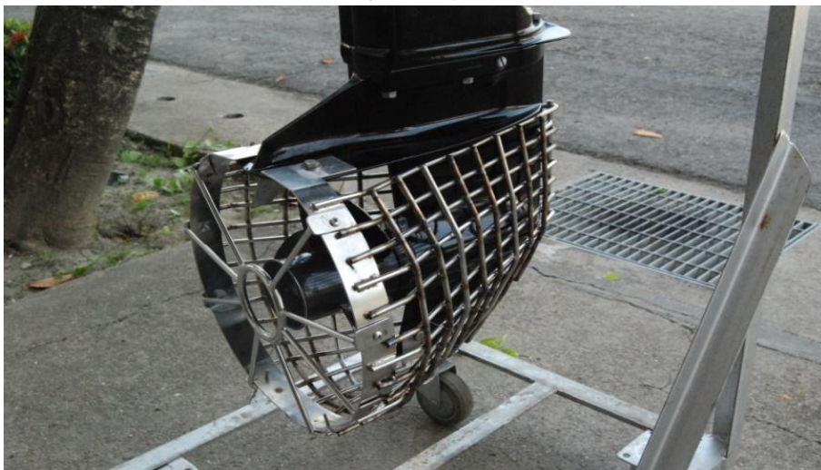
圖七 操舟機護罩研改Ⅱ型
