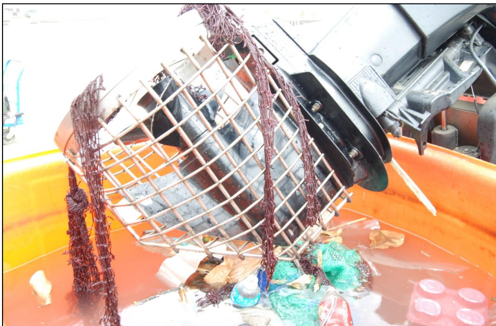
圖十六 75 匹操舟機研改護罩測試結果
