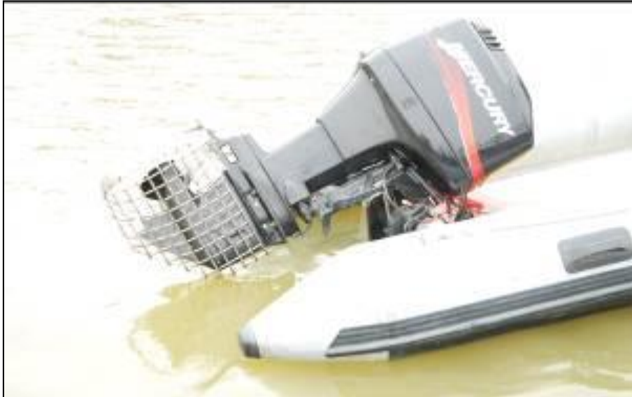
圖二二 75 匹操舟機研改護罩水上操行測試結果
