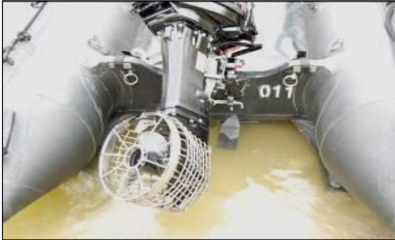
圖十八 30 匹操舟機研改護罩水上操行測試
