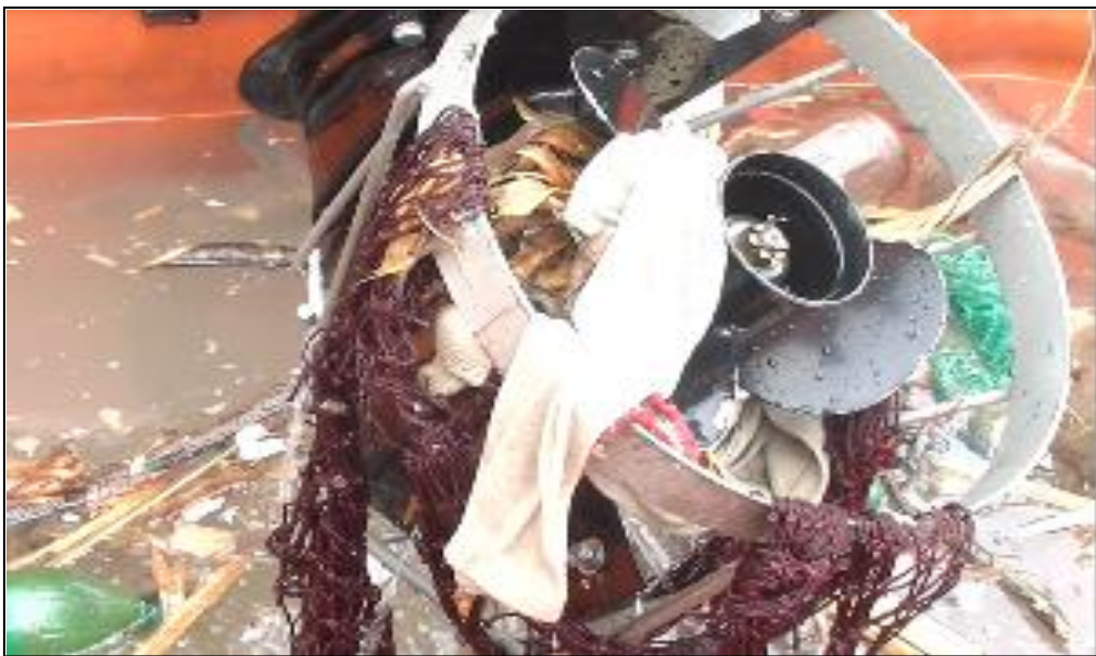
圖十一 30 匹操舟機原護罩測試結果
