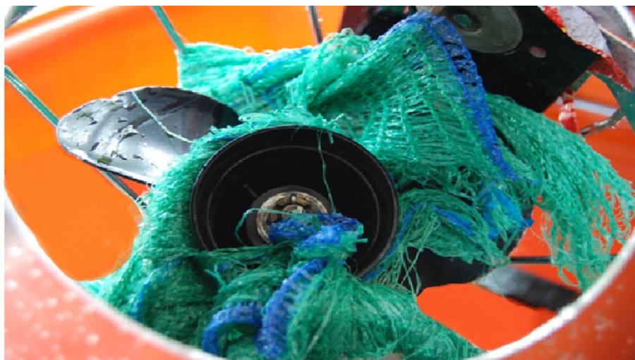
圖四 操舟機損壞情形
