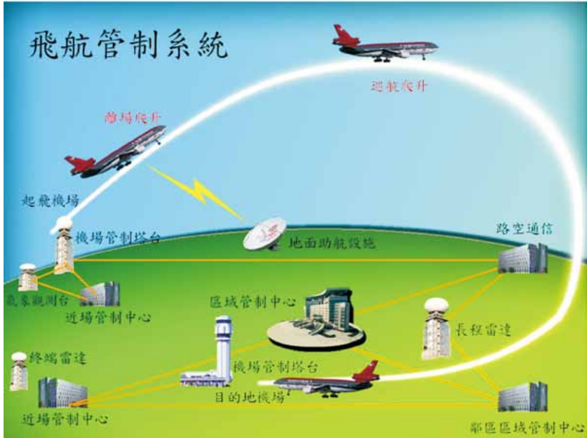
圖1 飛航管制系統(本研究整理)
