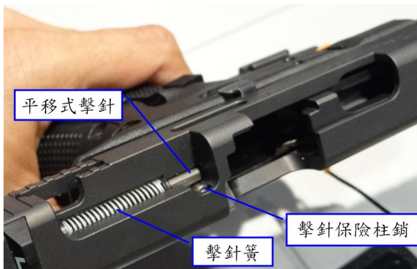
圖 9 GLOCK 獨特的擊針平移式擊發機構剖視
