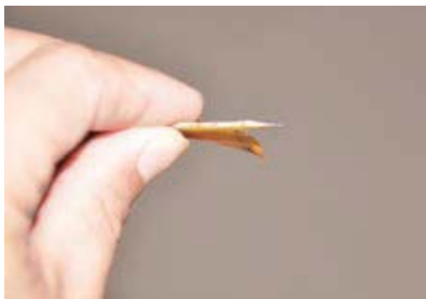
圖九 優力膠斜切面黏合處 (資料來源：作者拍攝)
