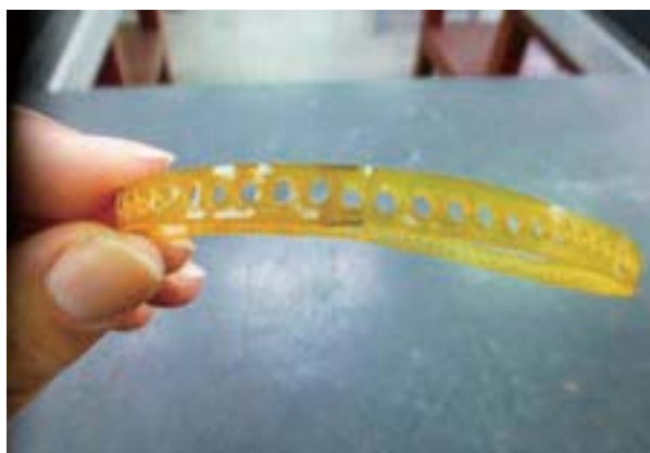
圖十三 測試後優力膠鏈條 (資料來源：作者拍攝)
