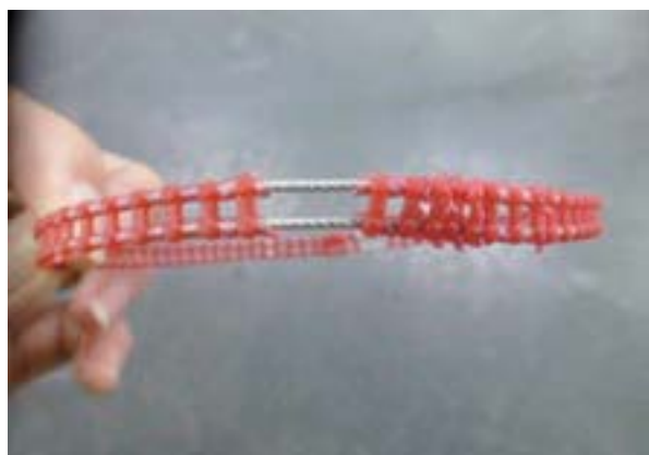
圖十四 測試後軍規鏈條 (資料來源：作者拍攝)
