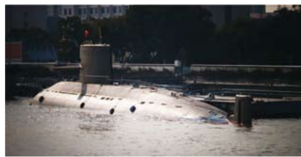
圖一 中共潛艦的潛航噪音過大，柴電潛艦以外購的基洛級與自研的039型較佳。039型潛艦至今已研發出6款，型號是：039、039G、039A、039AG、039B(圖示)、039C；其中以039C的靜音效果最佳，並採用燃料電池的絕氣動力系統(AIP)
