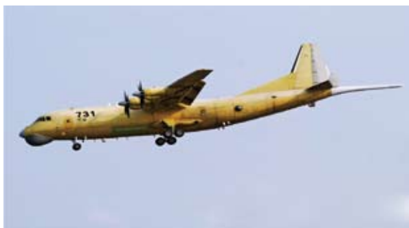
圖五 中共新近完成研發的「高新6號」固翼式反潛機，性能與美製P-3C反潛機相當，其特徵為：機首下方配置可360度環視海面的搜索雷達、尾部的「磁異探測儀」較P-3C反潛機長出一截。美國海軍新入役的P-8反潛機的性能則超越「高新6號」
