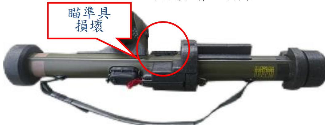
圖 11 檢查瞄準具有無霧化或損壞
