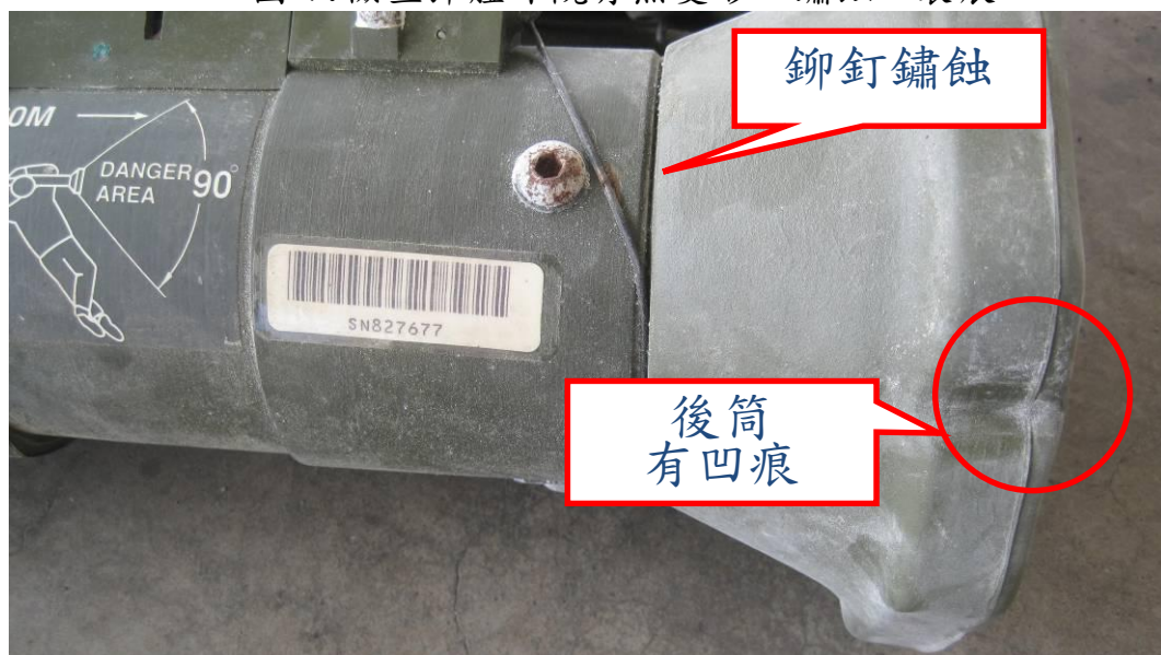
圖 7:檢查彈體外觀有無變形、鏽蝕、裂痕
