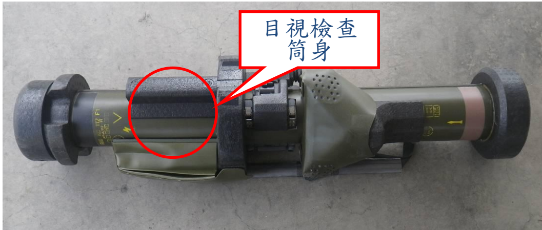
圖 10 檢查筒身有無變形、凹洞或裂隙
