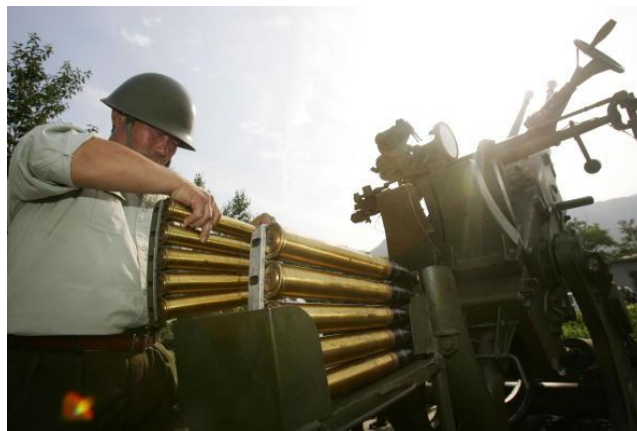
圖三：中共以高射砲發射碘化銀彈催雨
