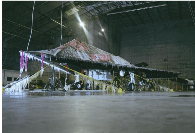
圖一：美軍F117隱形戰機在實驗室進行零下低溫實驗
