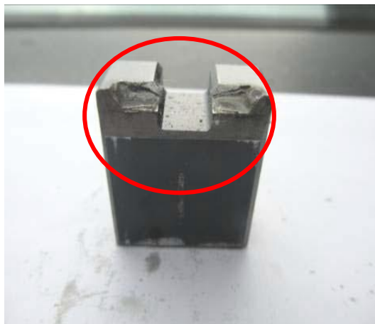
圖 1 閉鎖鐵斜面變形
