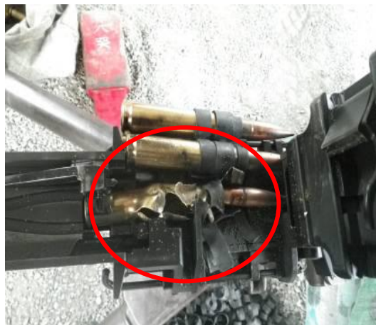
圖 5 熱噴流引發彈藥瞬燃
