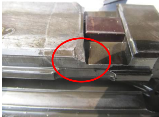
圖 2 槍機閉鎖鐵槽變形
