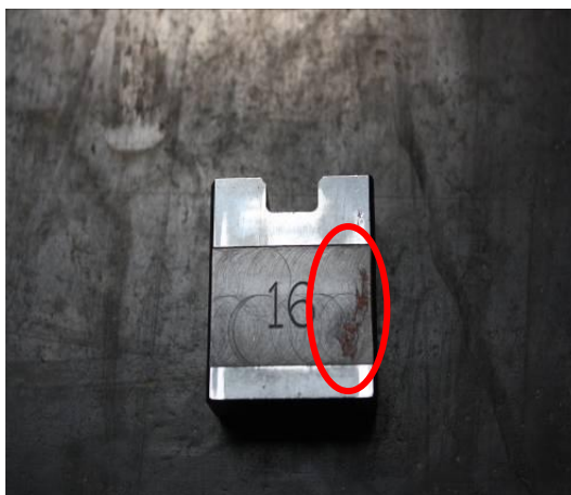
圖 7 委製閉鎖鐵表面鏽蝕
