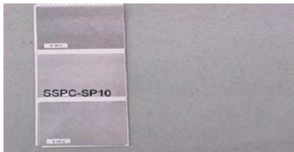
圖四 完成表面處理後，實施色樣參考比對檢驗
