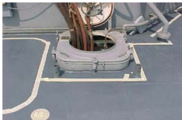
圖十 鋪設時應與甲板邊緣或垂直壁保持適當間距
