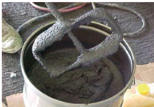
圖十一 防滑塗料使用前應予以適當攪拌混合
