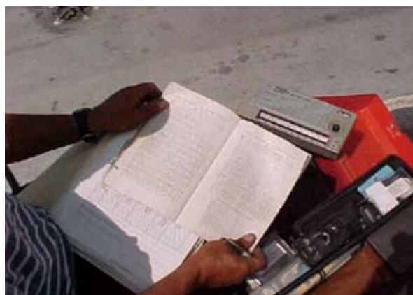
圖五 鋪設時嚴密監控環境狀況，對於塗料使用壽命有關鍵性的影響
