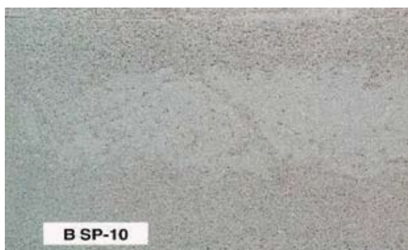
圖三 左圖是SSPC-SP10塗裝色澤參考，相較於右圖未施工前的生銹表面
