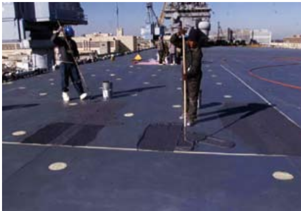
圖十二 滾刷防滑塗料須使用適當的滾筒，才能拉出最佳的防滑效果
