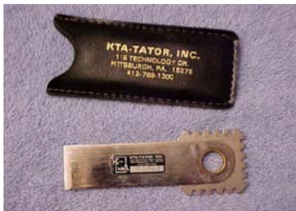
圖六 底漆濕膜厚度的測量必須在上漆後立即進行，以免因溶劑揮發而造成漆膜發生收縮現象，右圖為常見的濕膜厚度計
