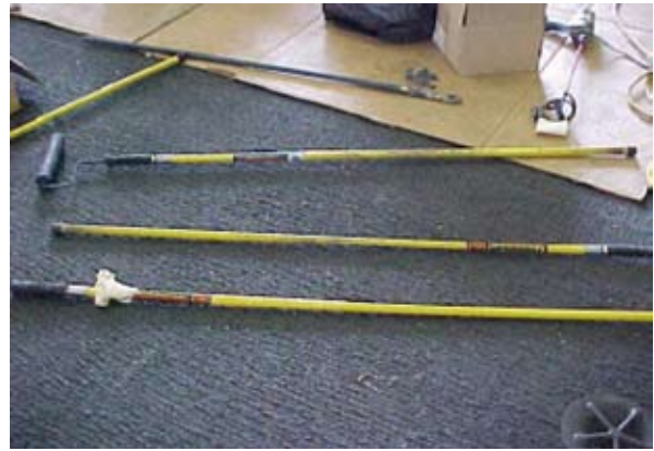
圖十二 滾刷防滑塗料須使用適當的滾筒，才能拉出最佳的防滑效果
