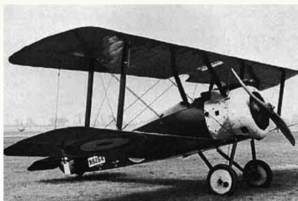
圖一 一次世界大戰中英國著名的駱駝式(Camel)戰機，為標準的雙翼機構型。(圖片來源：參考文獻15)
