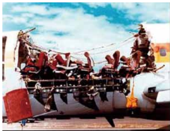
圖十五 1988年美國阿羅哈航空公司一架波音737-200型客機前機身撕裂脫落。(圖片來源：參考文獻19)
