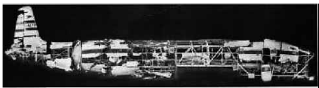
圖三 由地中海撈起的第一架彗星一號失事殘骸。 (圖片來源：參考文獻27)
