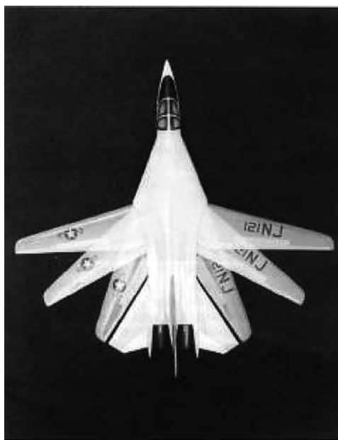
圖九 F-111的可變後掠機翼，可應運任務需要改變後掠角度。(圖片來源：參考文獻36)
