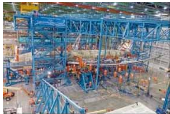
圖十一 大型商用客機執行全機疲勞試驗的情形。 (圖片來源：Internet)
