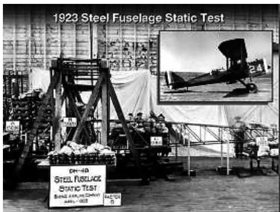
圖二 早期飛機實施靜力試驗的情形。(圖片來源：參考文獻22)
