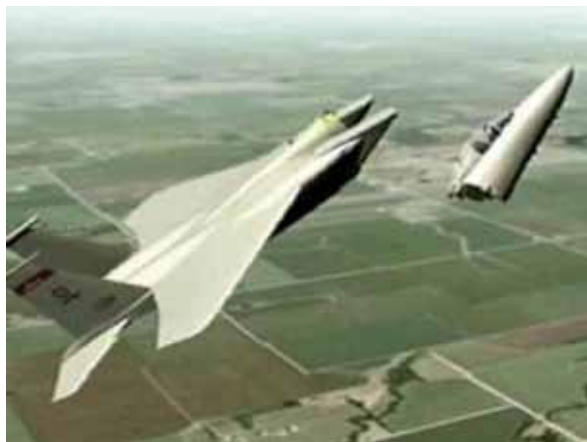
圖十八 2007年11月2日，美國空軍一架F-15C因結構疲勞而空中解體。(圖片來源：參考文獻31)
