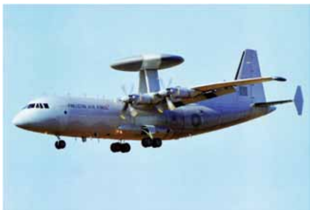
圖五 外銷巴基斯坦的ZDK-03預警機，載臺為運-8F-400加長型。
