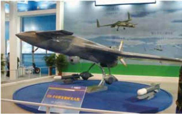
圖七 中共的CH-3(彩虹-3)無人機，用為攻擊機可掛載2枚AR-1空對地導控飛彈。
