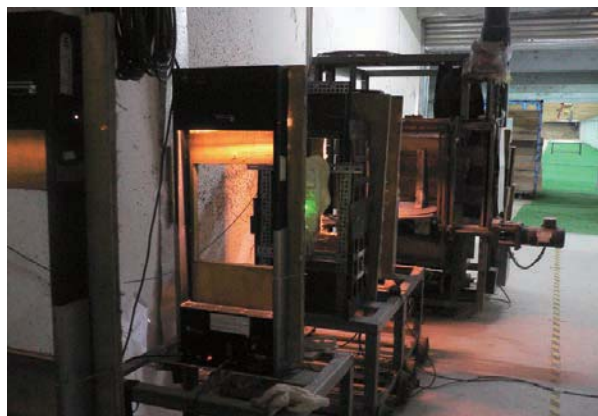
圖十一 9公厘實彈測試示意圖
