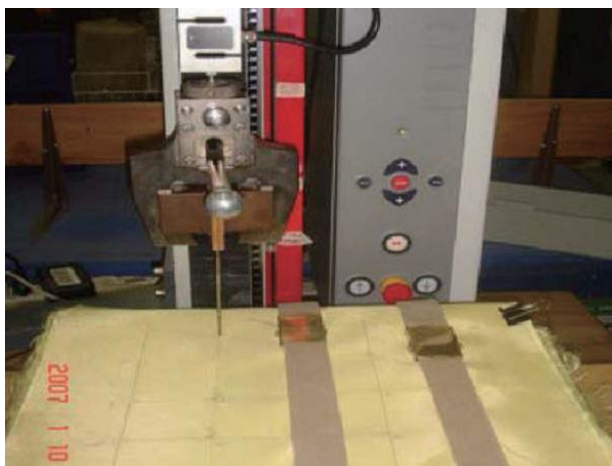
圖一 長釘及刀刃進行Quasistatic測試
