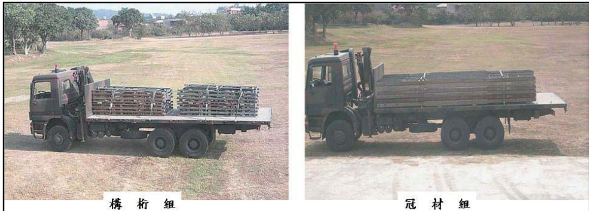
圖六 橋車裝載示意圖 2
