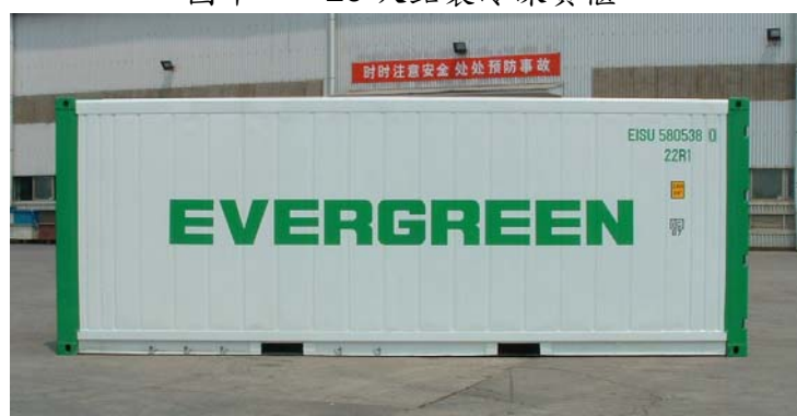
圖十一 20 呎鋁製冷凍貨櫃
