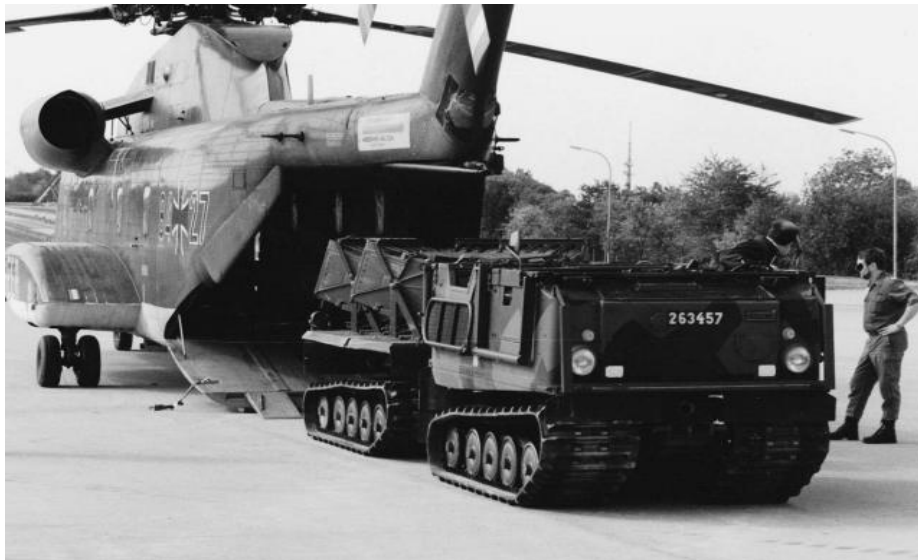
圖八 Bv 安裝 Skorpion-AB 之 206S 載具於 CH-53 直升機裝載情形
