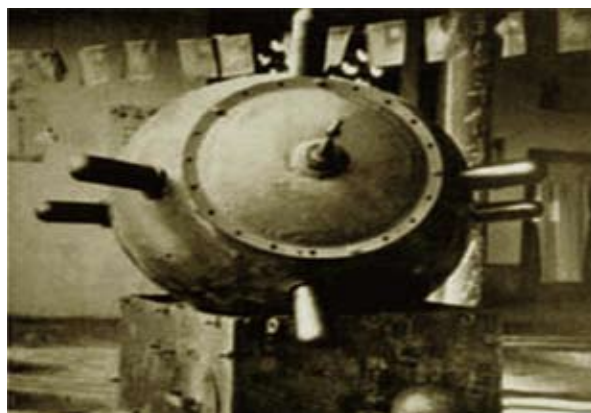
圖三 海乙式300磅觸發水雷
