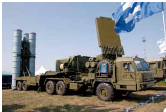
圖六 S-300PMU2的拖曳式發射車，後面是其96L6E搜索雷達。(作者提供)
