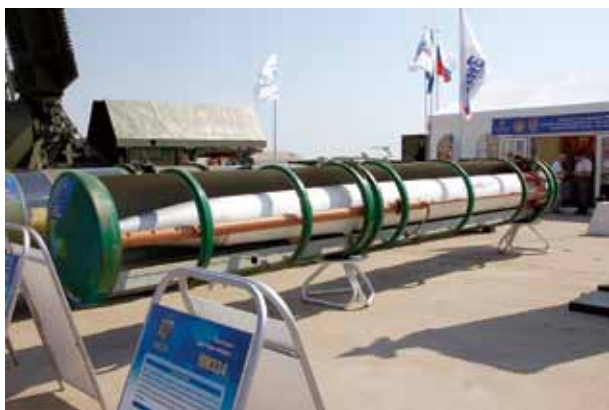
圖七 S-400所用的48N6E3防空飛彈，射程250km。可供外銷型S-400使用。(作者提供)
