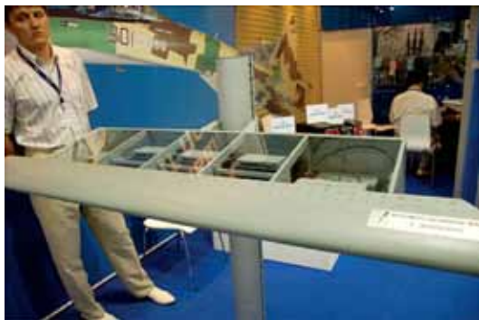
圖一 MAKS2009展出的AFAR-L，為裝設於戰機翼前緣的L波段相位陣列雷達。(作者提供)
