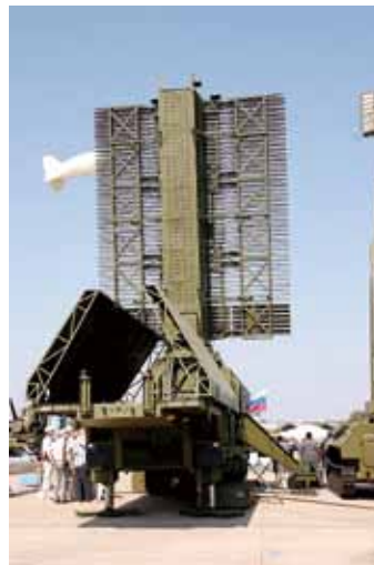
圖二 Protivnik-GE雷達，採用L波段，擁有相當大的探測距離與X波段等級的精度。(作者提供)
