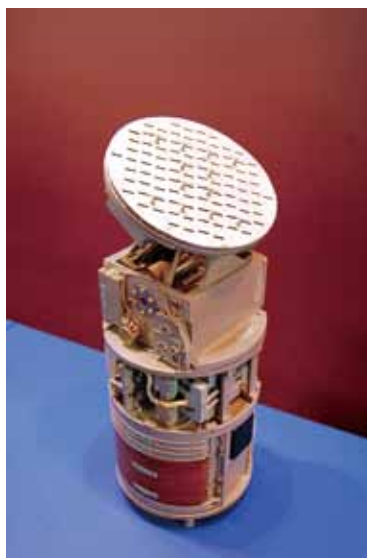
圖五 9B-1103M-200PA半主動-主動複合導引頭，由主動天線與寄生的半主動接收天線構成。(作者提供)
