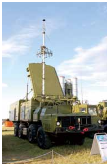
圖三 S-300PMU2的30N6E2(X波段)射控雷達，一套完整的S-300PMU2會有6部30N6E2，由搜索雷達接手射控任務，本身也可以充當搜索雷達。(作者提供)
