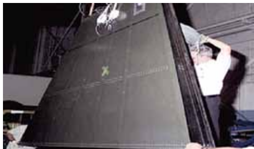
複合材料平價性倡議開發的類似F-35機翼結構 (圖片來源：參考文獻8)
