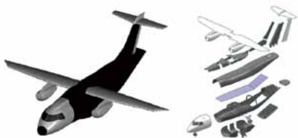
洛馬的設計以Do-328噴射客機為骨幹，淺色區域結構沿用自原機體，深色區域結構為新製件
