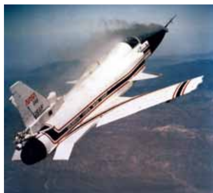
唯有複合材料才能滿足X-29A前掠翼驗證機的機翼氣動力設計需求(圖片來源：Internet)
