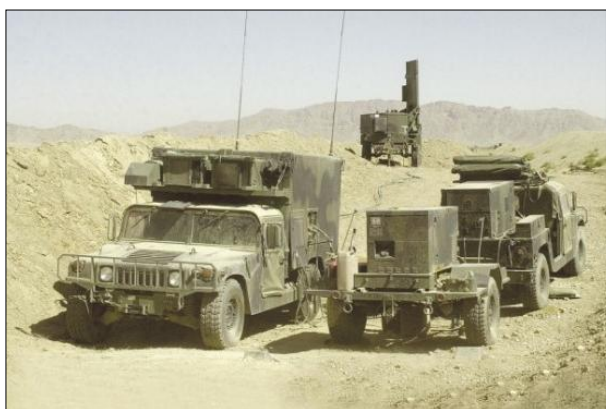
圖三 AN/TPQ-36（V）10 型反迫砲雷達
