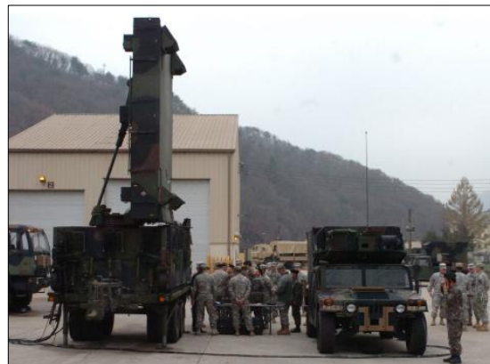
圖四 駐南韓美軍 210 火力旅展示之 AN/TPQ-37（V）9 型反砲兵雷達
