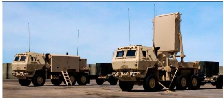
圖五 AN/TPQ-53 (EQ-36)「加強反火力目標獲得雷達系統」
