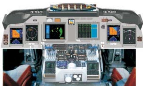
圖二 P-3C型機傳統駕駛艙與採用了電子飛行儀表系統駕駛艙比較圖
