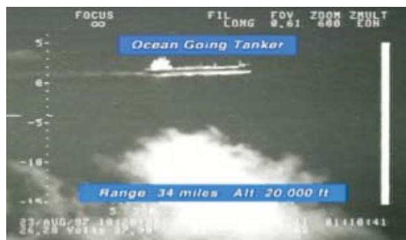
圖四 P-3C型機紅外線光電感測系統及偵測夜間活動目標的情形
