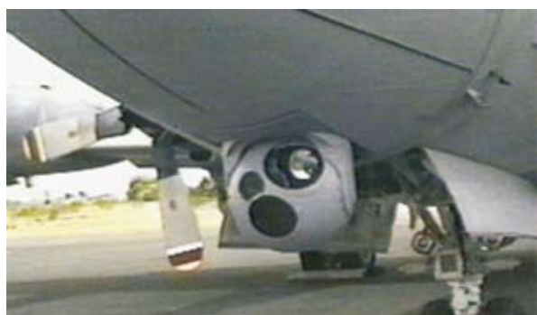
圖四 P-3C型機紅外線光電感測系統及偵測夜間活動目標的情形
