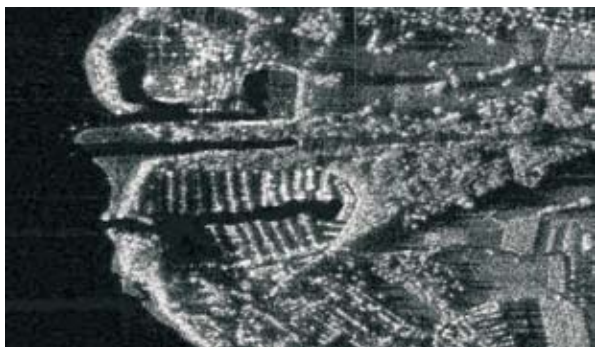
圖三 AN/APS-143雷達使用SAR模式地形比對及ISAR模式偵測水面目標
