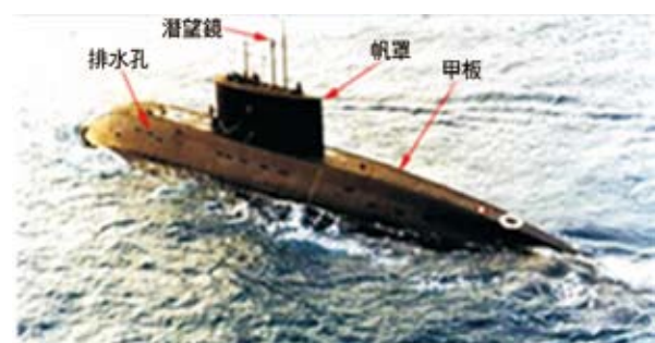
圖八 636型K級柴油動力潛艦
