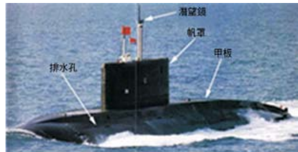
圖七 877型K級柴油動力潛艦
