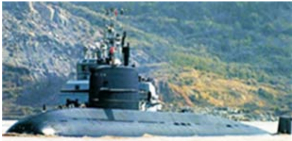
圖三 039A型柴電攻擊潛艦，北約稱爲「元級」
