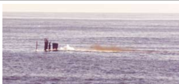
圖四 潛航中露出潛望鏡、天線與呼吸管的潛艦
