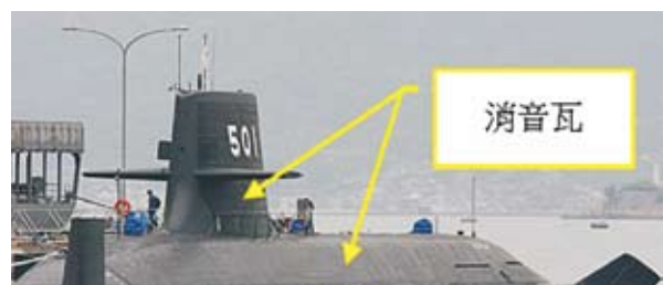
圖三 日本蒼龍級潛艦鋪設消音瓦圖
