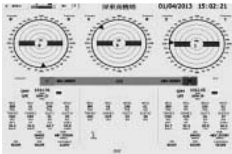
自動氣象觀測 系統(AWOS 顯示器AWOS Client端軟體)
