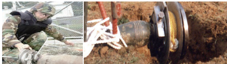
圖八 機械衝擊扳手卸火法示意圖(資料來源：同註4)
