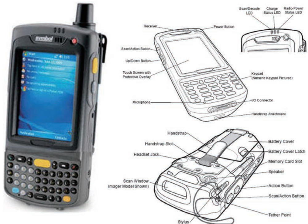
圖六 軍隊健康縱向科技應用系統-手持裝置應用機型構造(資料來源：同註13)
