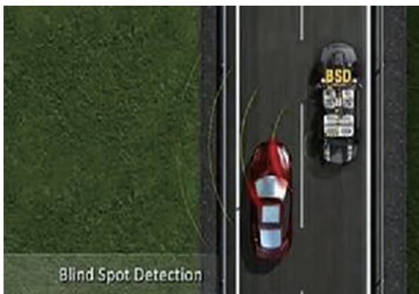
圖三 盲點檢測系統示意圖(資料來源：同註6)
