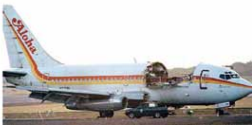
美國阿羅哈航空公司一架波音737客機前機身蒙皮因應力腐蝕裂紋而飛脫(圖片來源：參考文獻7)
