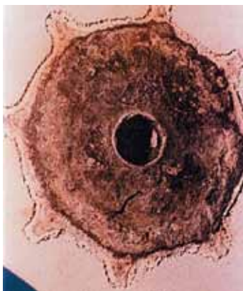
鎂金屬表面與不銹鋼件接觸面產生的電位腐蝕 (圖片來源：參考文獻9)
