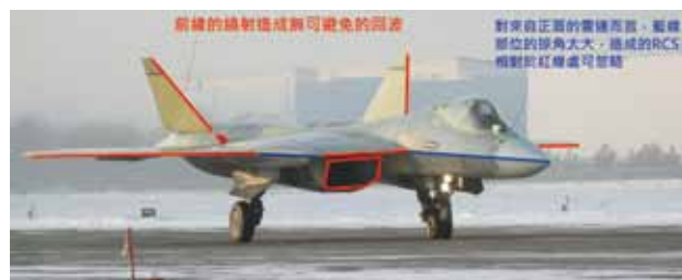
圖二 邊緣無可避免的會有繞射，對來自正面的雷達波而言，又以翼前緣、進氣口影響為最。 (資料來源：www.sukhoi.org)
