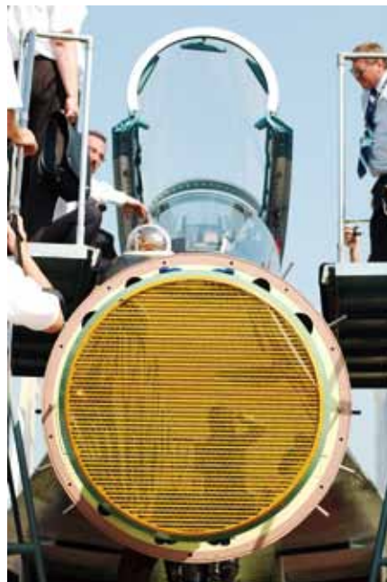
圖七 Su-35卸除雷達罩後正面特寫，機首周圍有若干短金屬柱狀物就是其大氣數據感測器。 (資料來源：作者提供)
