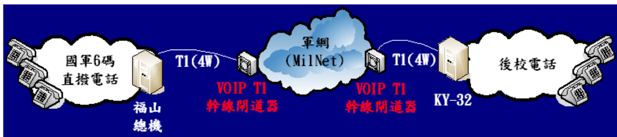
圖七 福山總機以「VoIP」閘道器連結聯合後勤學校 KY-32 示意圖 (資料來源：作者繪製)
