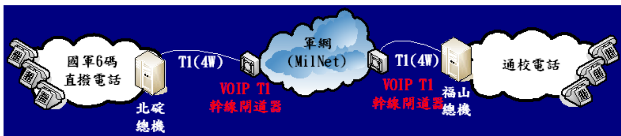
圖五 北碇總機以「VoIP」開道器連結福山總機示意圖(資料來源：作者繪製)
