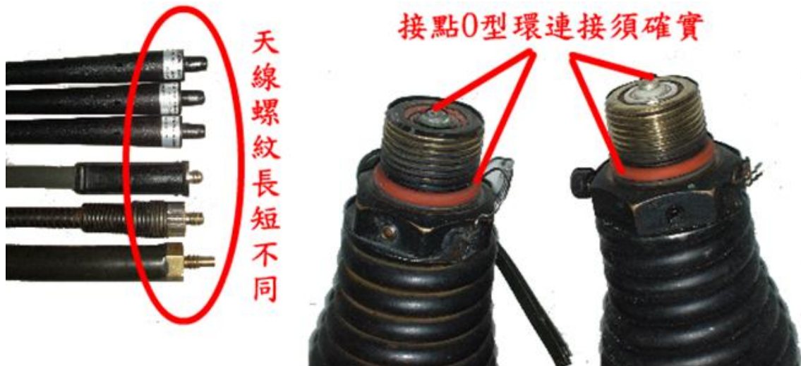
圖四 天線及匹配器接點 (資料來源：作者繪製)
