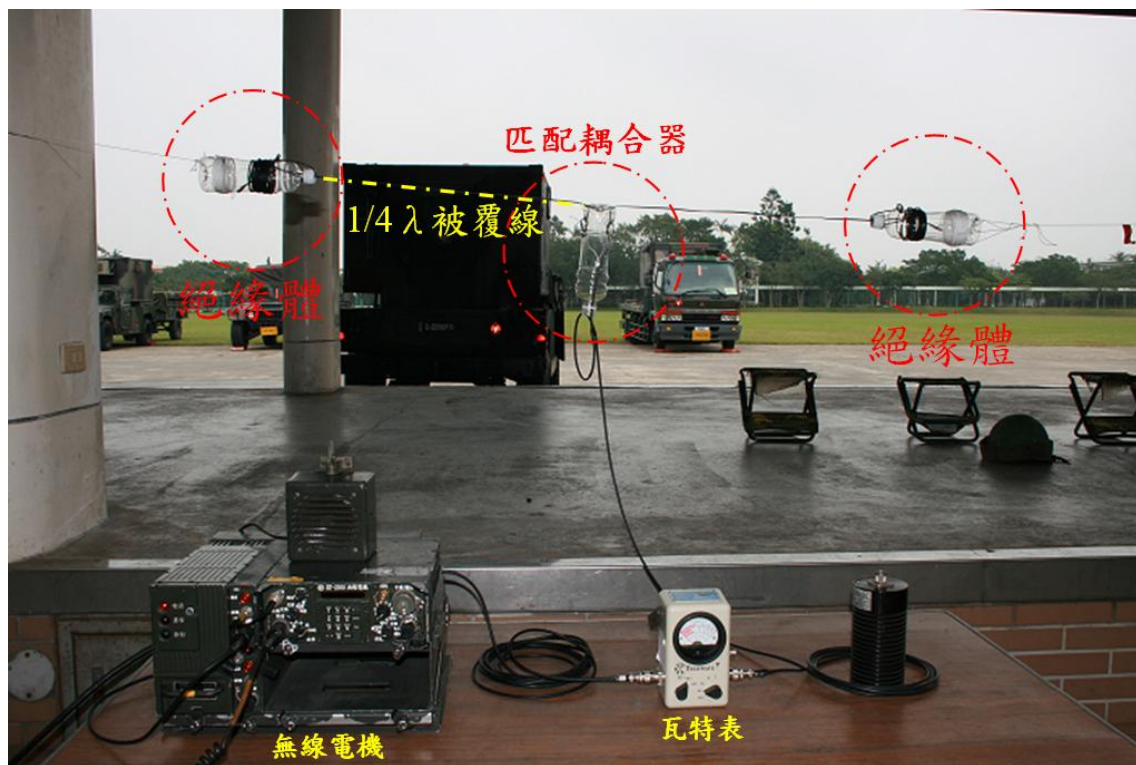
圖八 野戰型急造天線驗證架構(資料來源：作者整理)
