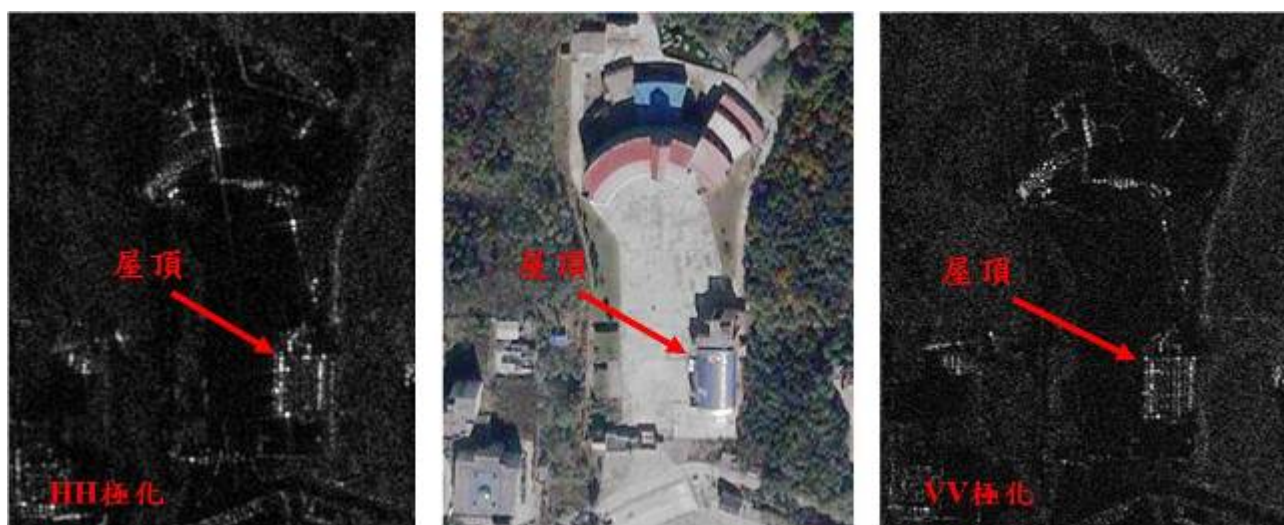
圖八 HH 極化與 VV 極化影像比較(資料來源：TerraSAR-X 及 QuickBird 衛星影像，作者處理繪製)
