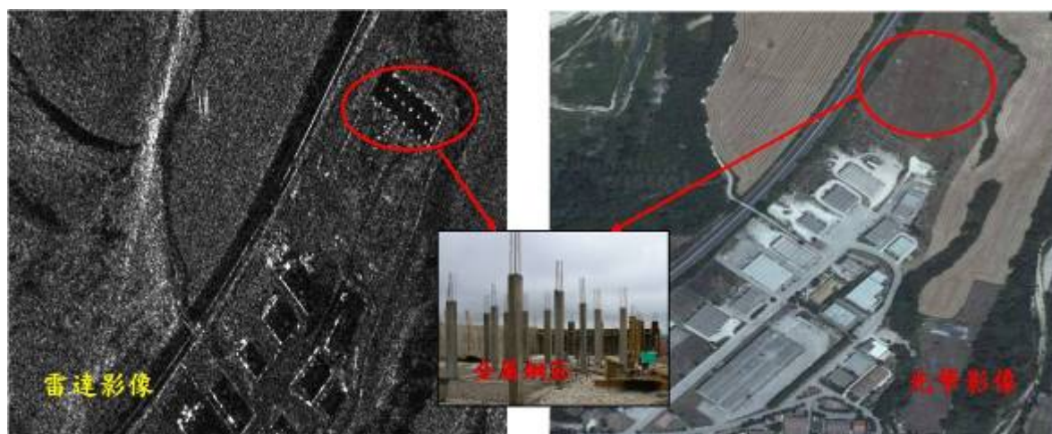
圖五 光學影像與雷達影像對金屬物質偵測辨識比較 (資料來源：作者繪製)
