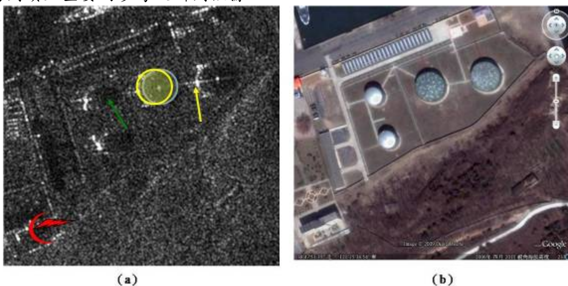
圖十六 (a) 儲油槽雷達HH影像；(b) 儲油槽光學影像(資料來源：TerraSAR-X 及Google Earth衛星影像，作者處理繪製)
