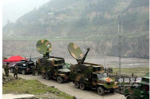
圖十二 5月17日成都軍區某通信部隊在汶川災區架設衛星通信站(資料來源：中國軍網，中國軍人大救援-某通信部隊在汶川架設通信機站，2008年5月20日， http://www.chinamil.com.cn/site1/2008a/2008-05/20/content_1261980.htm )
