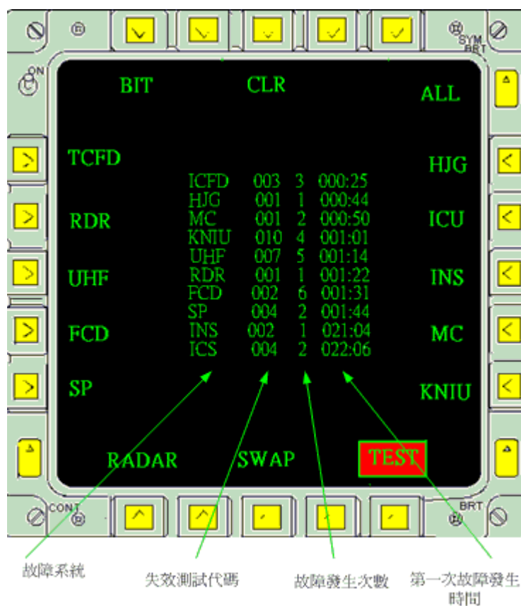
圖五 故障偵錯列碼回應清單 (資料來源: CAF IF-CK1A-2-94FI-00-1, 武器系統故障隔離技術手冊, 航空發展中心, 民國 81 年, 頁 5~9。)
