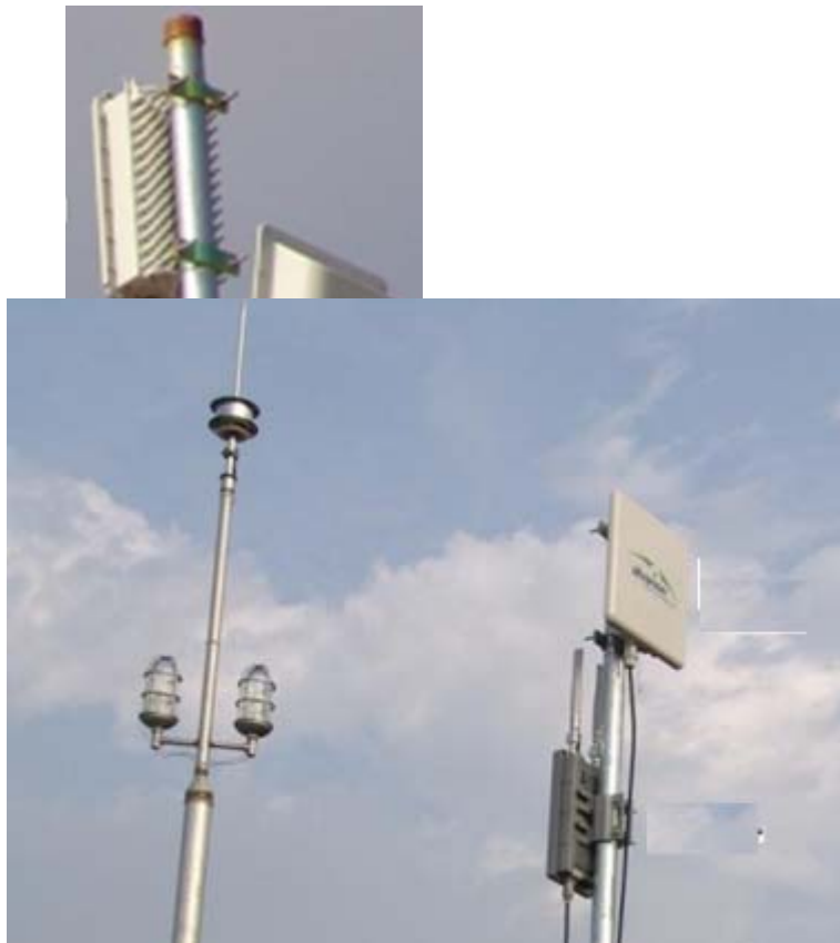
圖四 WiMAX 網路微波天線展示圖 (資料來源：WiMAX Forum, http://www.WiMAXforum.org/product )
