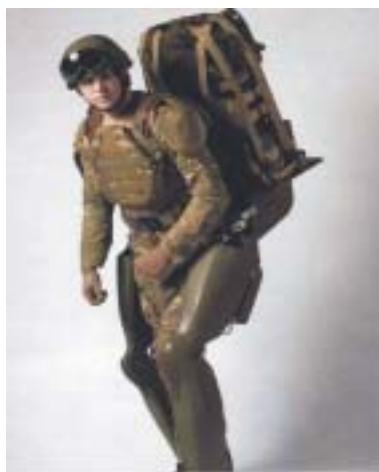
圖二 由加州大學柏克萊機械及人類工程實驗室所設計的「人造骨架」，雖然「人造骨架」重達100磅，但它可使士兵背負一個70磅背包，感覺有如5磅之重而已，但此技術目前只是在雛型階段。
