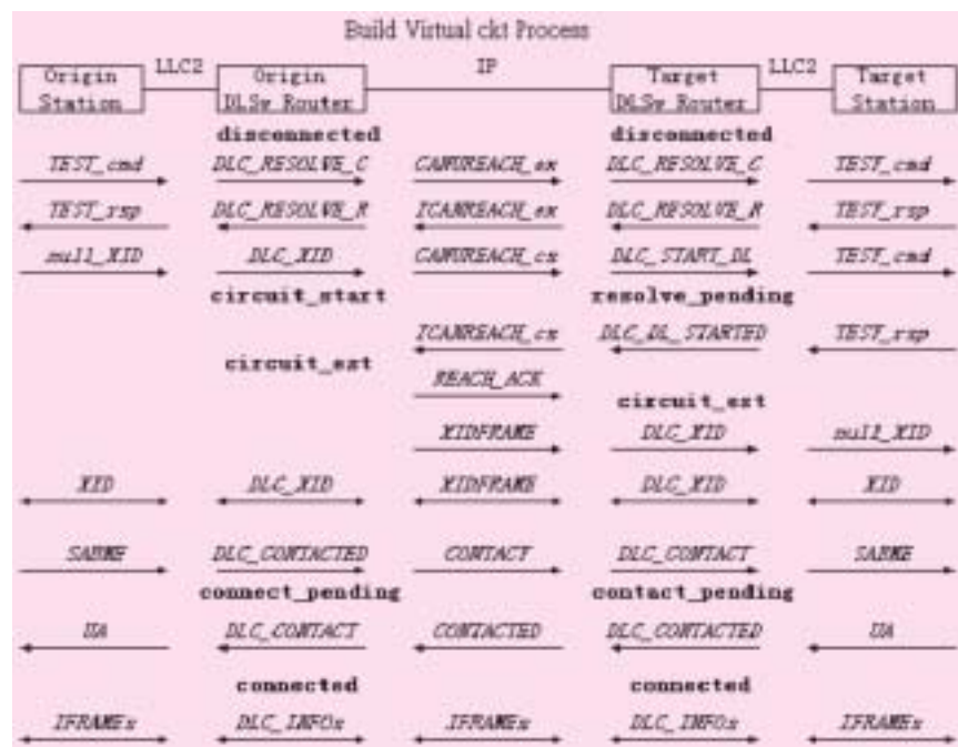
圖十四 建立SNA虛電路過程示意圖（作者繪製）
