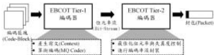
圖七 EBCOT編碼流程的示意圖 (作者繪製)
