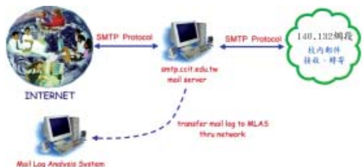
圖六 系統硬體架構圖 (作者繪製)
