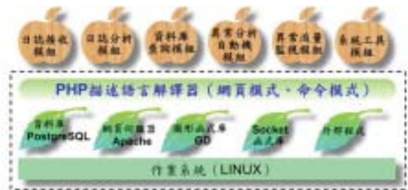
圖五 系統軟體架構圖 (作者繪製)
