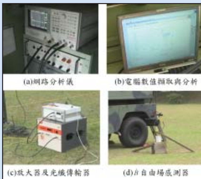
圖十九 量測信號擷取與分析所需之儀表 (作者拍攝)
