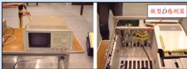
圖二十五 示波器機殼屏蔽效值之高能暫態測試(作者拍攝)
