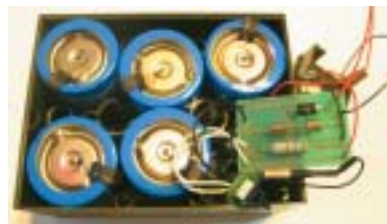
▲圖十二 軍用鋰硫電池BA-5598C之內部保護電路
