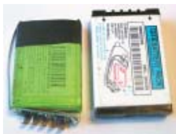
▲圖十 CD-928手機3.6V/800mAh的方型鋰離子電池組
