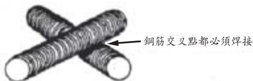
▲圖十 鋼筋交叉點都必須焊接②①
