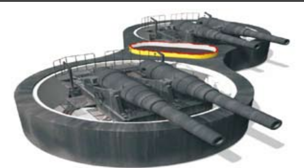
圖十一 定遠艦「兩門、四管」305mm主砲 資料來源：原繪圖者吳欲賢先生提供。
